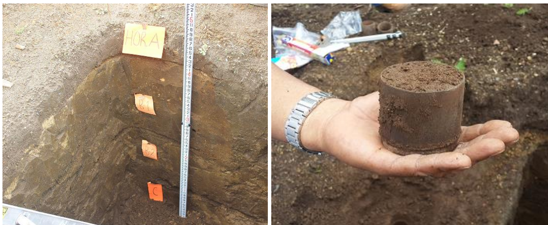
Fotos 3 y 4. Perfil mostrando 4 horizontes y cilindro uplah con muestras sin alterar
