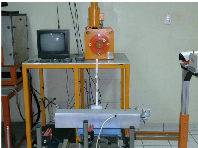
**Figura 2 :** Sistema instalado frente a un irradiador de Cs-137 para caracterización del haz en el Laboratorio Secundario de Calibraciones Dosimétricas (LSCD) del IPEN.
