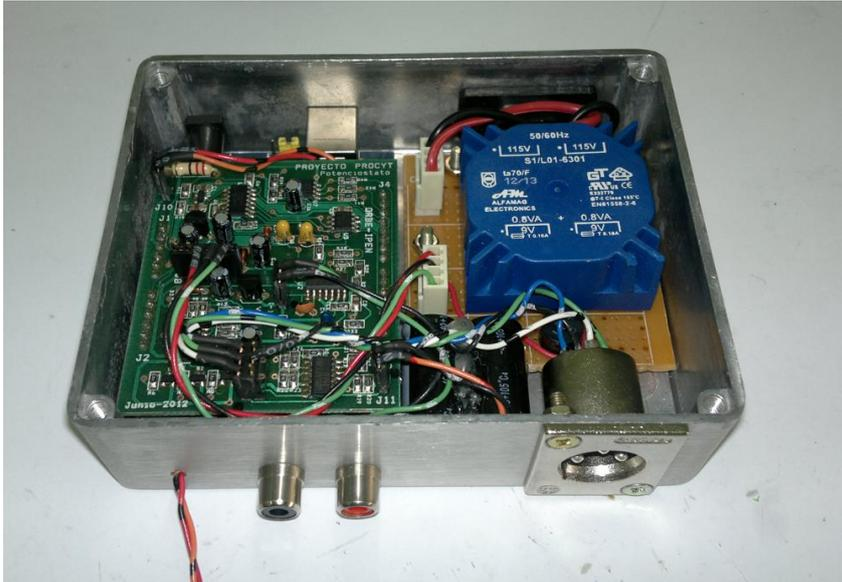
**Figura 2.** Gabinete de aluminio conteniendo la tarjeta de potenciostato, tarjeta arduino Duemilanove y tarjeta de alimentación de voltajes.
