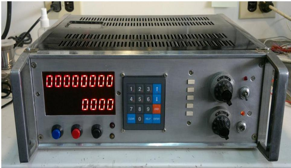
**Figura 2:** Vista del panel frontal modificado para incluir las actualizaciones de hardware
