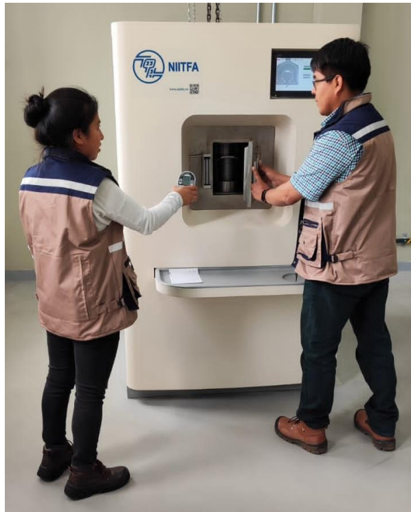
Imagen 2: Primera prueba con blindaje (Irradiación y dosimetría con Alanina).
