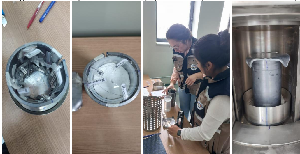
Imagen 2: Primera prueba con blindaje (Irradiación y dosimetría con Alanina).
