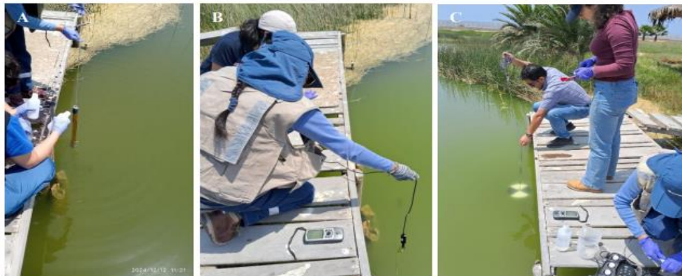
Imagen 3. Trabajo de muestreo en Humedal Albuferas de Medio Mundo, Huaura- Lima-Perú. (A) Toma de muestra de agua para análisis molecular de cianobacterias. (B) Medición de parámetros fisicoquímicos in situ. (C) Medición de transparencia usando disco Secchi
